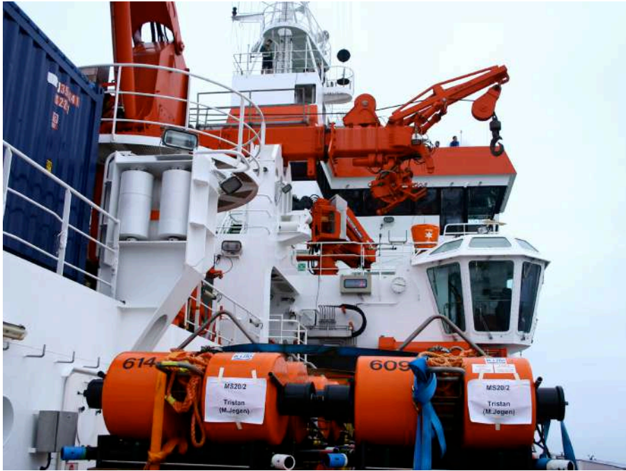
Flotteurs de stations sismologiques sur le navire océanographique allemand M.S Merian Port de Walvis Bay, Namibie, 2012
