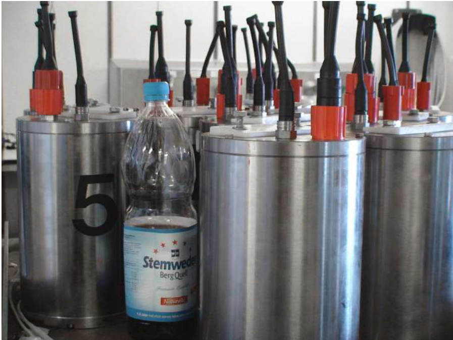
Roulis et Stewweder naturelle colorée entourée des magnétographes étanches en titane des stations OBEM Merian, 2012
